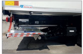
Rétraction par coulisses chromées, assurant un parfait guidage précis et durable
